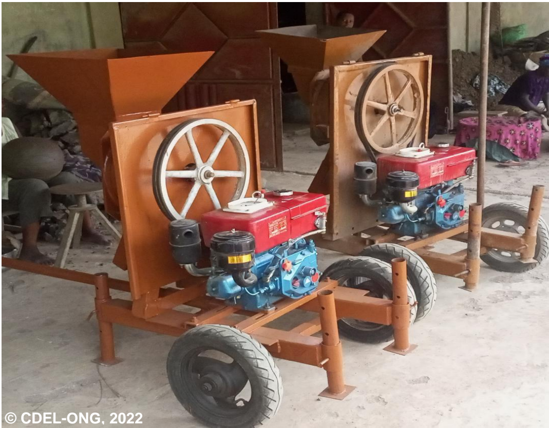
Photo 8 : Vue de loin des deux concasseuses à moteur diesel 6 chevaux
